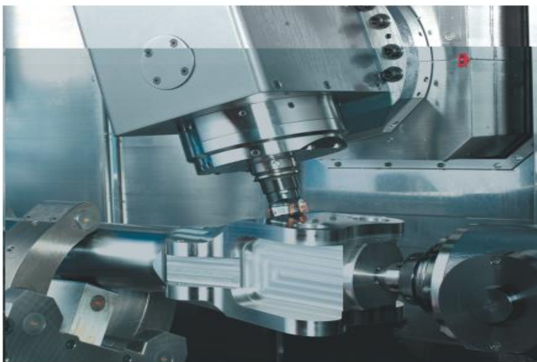
7.10-rasm. PUMA SMX turkumidagi ko'p vazifali tokarli-frezerli DOOSAN Infracore mashine Tools kompaniyasining dastgohining ishlov berish jarayonining ko'rinishi.
