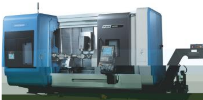
7.11-rasm. PUMA SMX turkumidagi ko'p vazifali tokarli-frezerli DOOSAN Infracore mashine Tools kompaniyasining dastgohining umumiy ko'rinishi.
