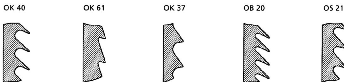
Рис.112. Типы гарнитур дискретизирующего барабанчика ОК40 – для хлопка и смеси; ОК61- для химических волокон и их смеси; ОК37- для синтетических волокон; ОВ20 – для 100% хлопка; ОС21- для вискозы и смеси.
