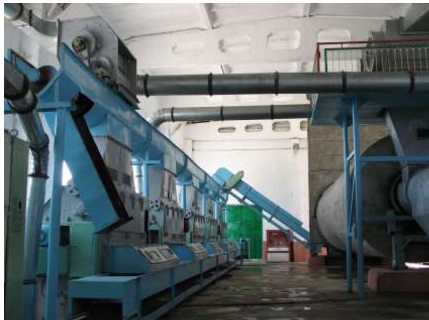
30-rasm. 2SB-10 rusumli barabanli quritgichlar va paxtani tozalash uskunalari o'rnatilgan QTB ning umumiy ko'rinishi.
