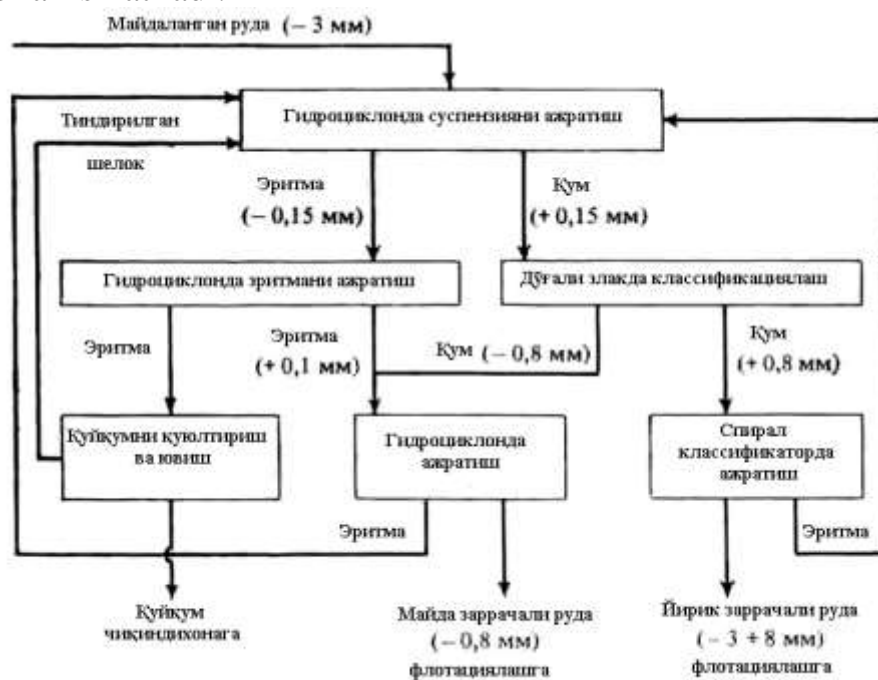
9 – rasm. Silg'vinit rudasini quyqumsizlantirish sxemasi.
