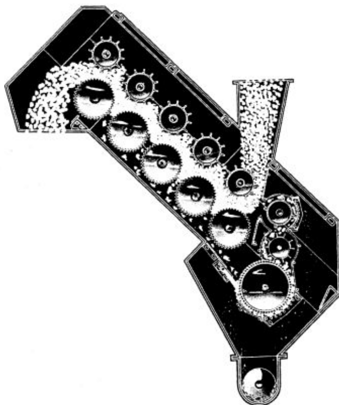
1.9-расм. Continental Eagle” корпорациясининг қозикчали-аррачали барабанли қия тозалагич схемаси
