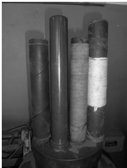
Рисунок 3. Патроны с податливой системой, наклеенной на поверхность патрона
