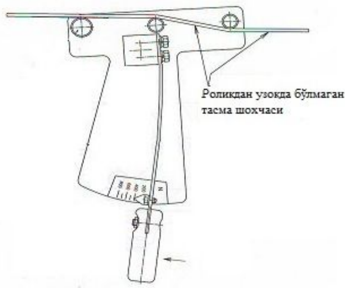
4.26. расм. Қайиш таранглигини диагностикалаш мосламаси
