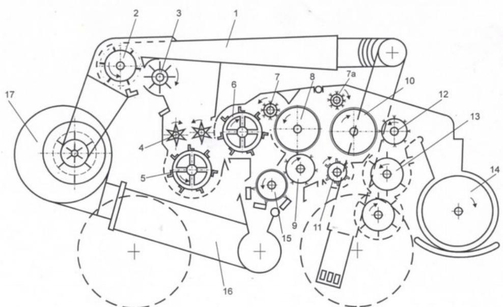
1 - труба, 2 - сепаратор, 3 - вакуум-клапан, 4 - питающие валики, 5, 6 - рыхлительные лопастные барабаны, 7, 7а - подающий и сбрасывающий щеточные валики, 8, 10 - пильчатые барабаны, 9, 12 - снимающие щеточные барабаны, 11 - возвращающий лопастной барабан, 13 - колковые рыхлительные барабаны, 14 - выгружающий шнек, 15 - пильчатый регенерационный барабан, 16 - трубопровод, 17 - вентилятор
