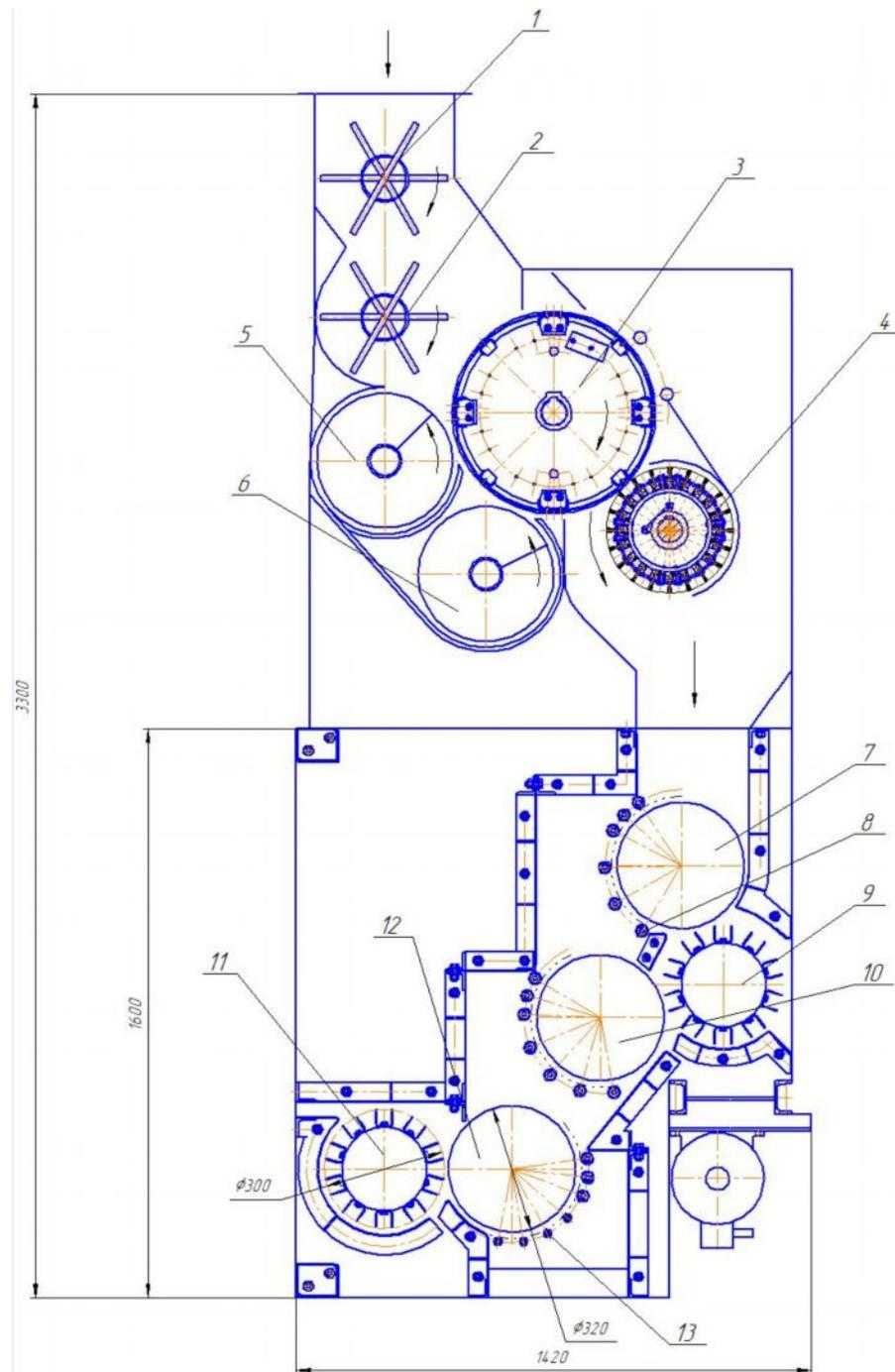
1,2 – прутковые барабаны, 3,4 - шнек, 5 – пильчатый барабан, 6-щеточный барабан,7,10,12 - пильный цилиндр, 8,13 -колосник, 9,11 -планчатый барабан.
