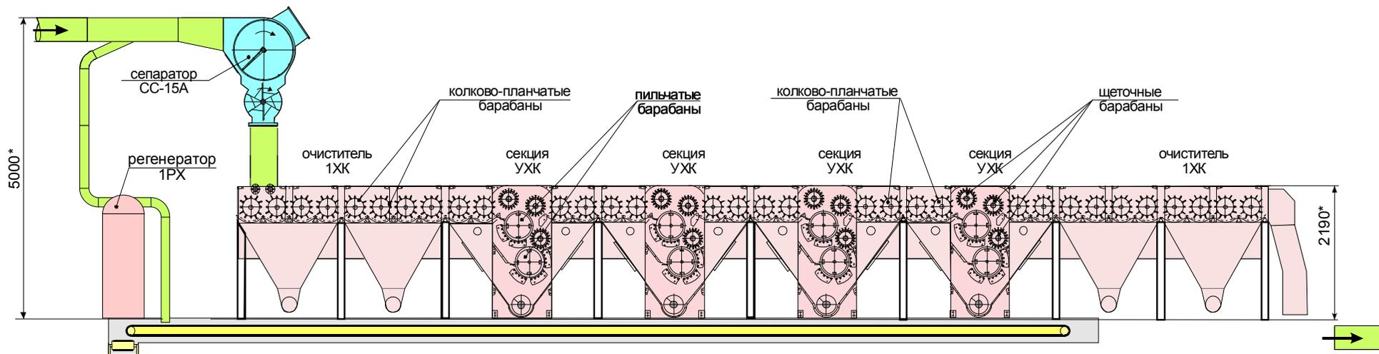
Рисунок 4. Схема серийного хлопкоочистительного агрегата УХК с пристыкованными очистителями 1ЖК.
