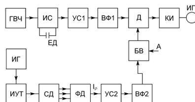
Рис. 8. Структура двухканального влагомера
