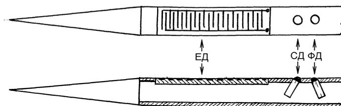
Рис. 9. Зонд для измерения влажности волокна в кипах.
