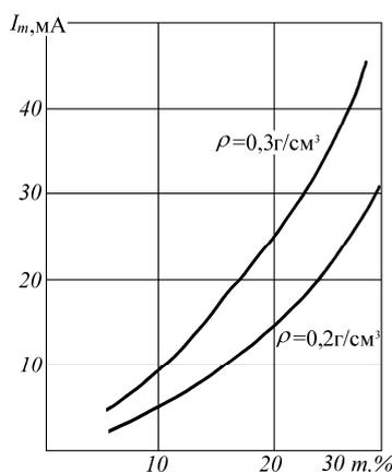
Рис. 1. Влияние плотности волокна на показание емкостного преобразователя
