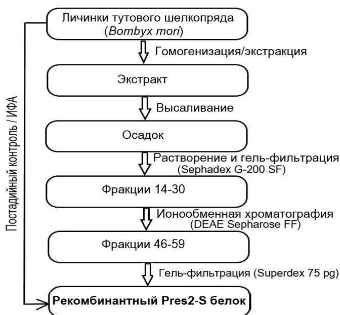
Рисунок 10. Схема выделения и очистки рекомбинантного PreS2-S белка
