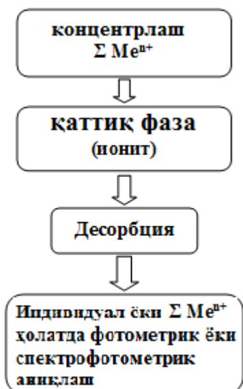
6-расм. Дастлабки концентрлаш ёрдамида оғир металларни аниқлаш схемаси.
