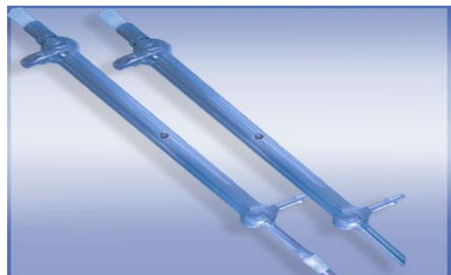
Рис. 1.4. Холодильники: шарообразный-обратный и Либиха.
