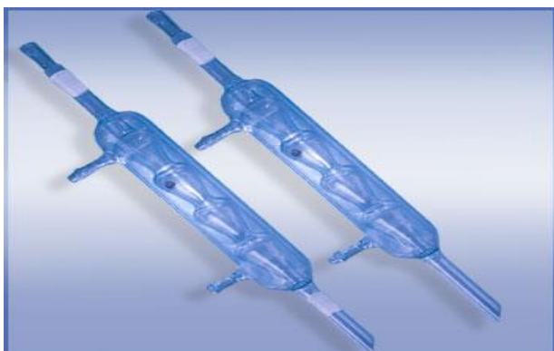
Рис. 1.4. Холодильники: шарообразный-обратный и Либиха.
