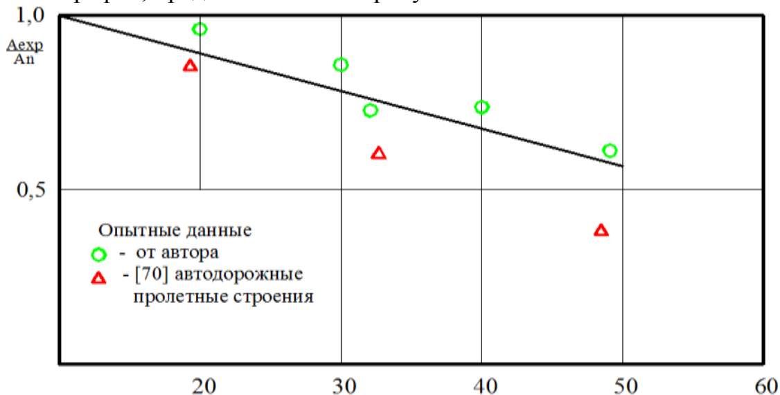
Рисунок 4. Изменение площади сечения арматуры, подвергшейся коррозии в процессе эксплуатации
