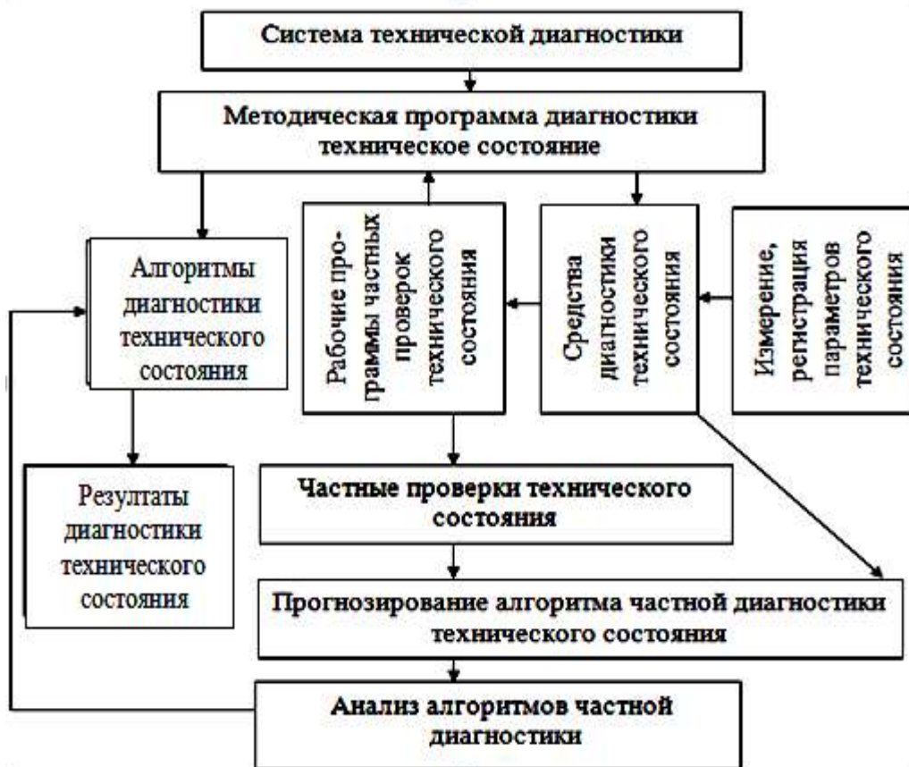
Рисунок 1. Система технической диагностики мостовых сооружений
