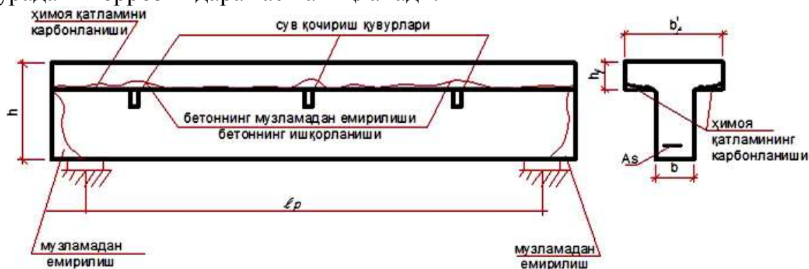
2 - расм. Оралиқ қурилмаси юк кўтариш қобилиятига таъсир этиб бетон мустаҳкамлигининг пасайиши мумкин бўлган қисмлари
