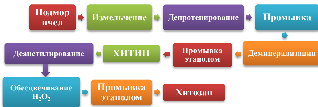
Рис. 1. Схема выделения хитина и хитозана из разных видов сырья
