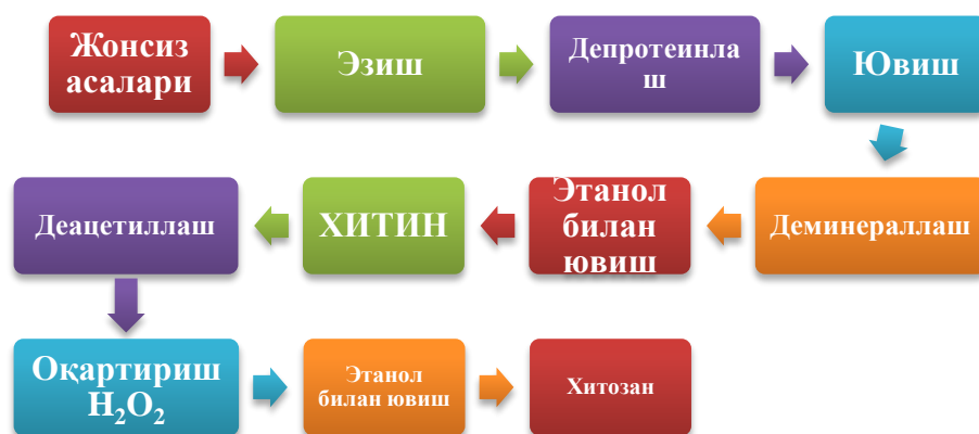
1-расм. Турли хил хом ашёлардан хитин ва хитозан ажратиб олиш схемаси.
