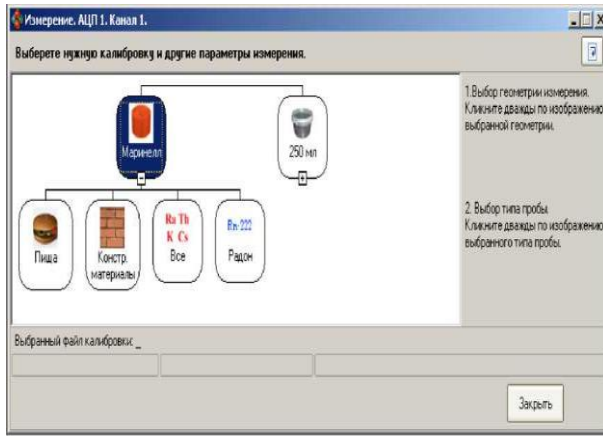
3-расм. МКГБ-01 радиометрини даражалашда ўлчаш параметрларини танлаш
