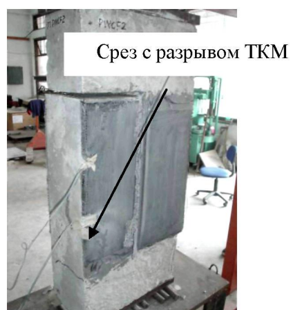
Рис. 11. Разрушение спецобразца и разрыв ТКМ по плоскости среза PF1
