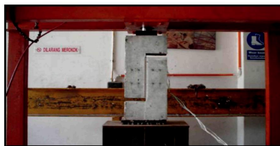
Рис. 9. Экспериментальная установка для испытания образцов–дисков при срезе
