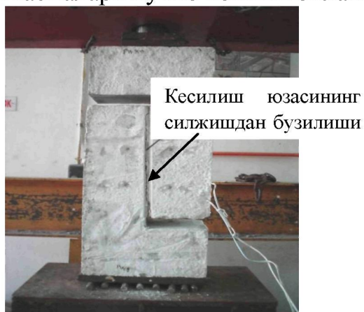
10–расм. P1 кучайтирилмаган намунанинг кесилиш текислиги бўйича бузилиши
