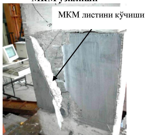
13 –расм. махсус PF3 намуна бетонининг сиртидан МКМлистини қатламлаб кўчиши (орқа томони)
