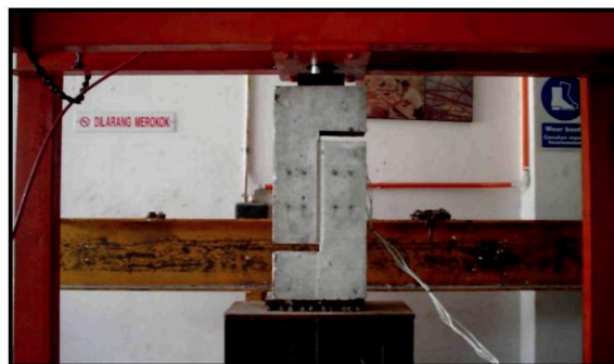
9–расм. Кесилишда дисксимон намуналарни синаш учун мўлжалланган экспериментал қурилма
