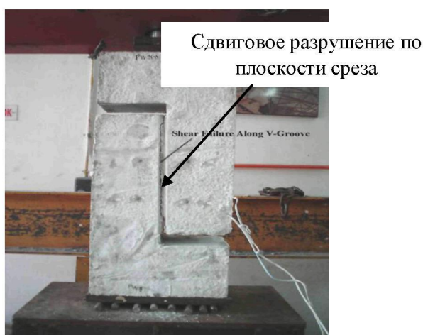
Рис. 10. Разрушение по плоскости среза неусиленного образца P1
