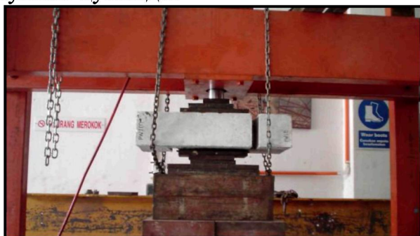
8–расм. Кесилиш текислиги бўйича чизикли ёрувчи юк берилган махсус қурилма
