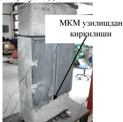
11 –расм. Махсус намунанинг бузилиши ва PF1 нинг кесилиш текислиги бўйича МКМ узилиши
