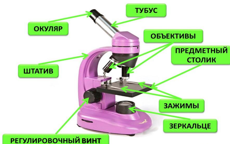
Рис.1, А. Строение микроскопа.
