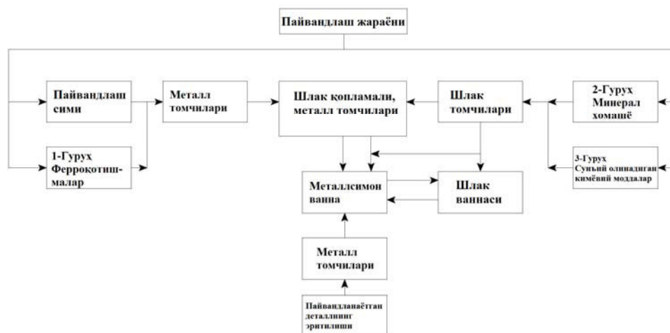
3-расм. Флюс остида автоматик ёйли пайвандлашда чок металининг қуйма структураси шаклланиши жараёнининг блок схемаси.
