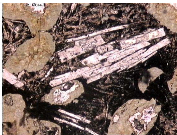
2-расм. Арватен кони диабазининг 160 марта катталаштирилган микроскопик тасвири
