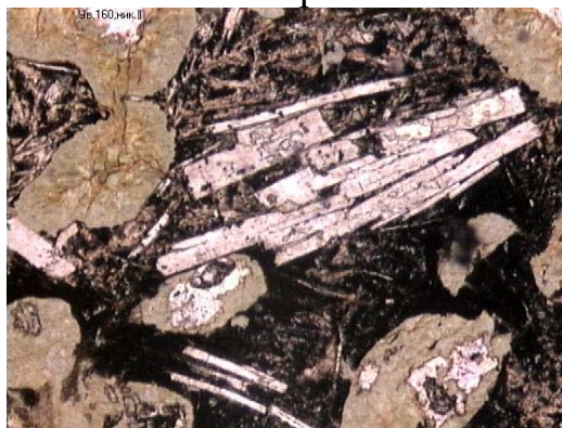
Рис.2. Микроскопическое изображение диабаз Арватенского месторождения при 160-кратном увеличении
