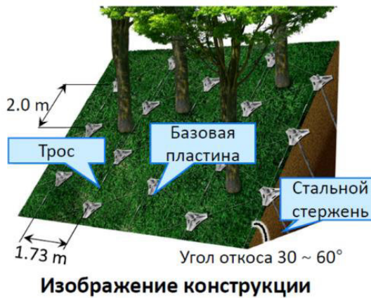
Рис. 12. «Нерешёточный метод» укрепления устойчивости склонов.
