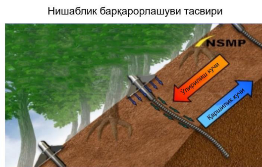
12-расм. Нишаблик турғунлигини мустаҳкамлаш учун «решоткасиз услуб».
