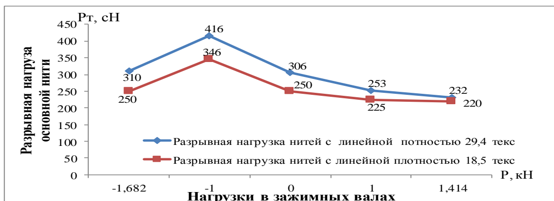
Рис. 2. Действия нагрузки давления зажимных валов шлихтовальной машины на разрывные нагрузки нитей с линейной плотностью T_0=29,4 текс и T_0=18,5 текс.
