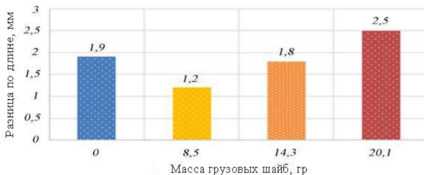
Рис.6. Разница в длине отдельных одиночных пряжи при изменении весовой нагрузки T_{пр}=29,4 \times 2 текс толщиной крученной пряжи (число кручений K=296 кр/м).
