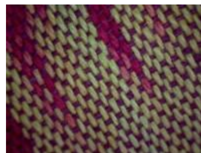
б) основная и уточная нить хлопковая
