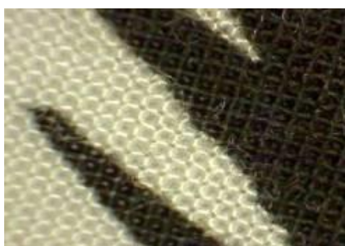
а) Нақш босиш усули билан “абрбанд” безаги туширилган мато (танда ва аркок ипи пахта)
