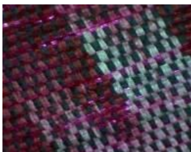
а) основная нить химическая, уточная нить хлопковая
