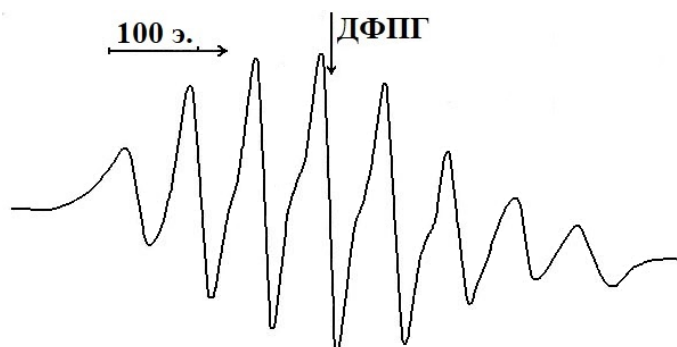
3-расм. (\text{VO})_2\text{L}^{10} \cdot 2\text{Py} комплекснинг толуол эритмасида олинган ЭПР спектри (293 К)
