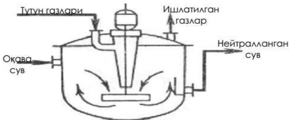
1.4-Rasm. Ishqoriy oqova suvlarni tutun gazlari bilan neytrallash qurilmasi.
