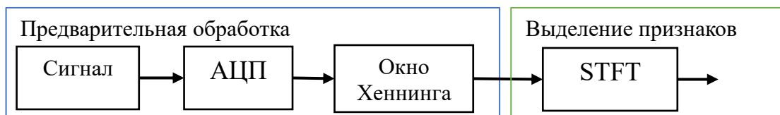
Рис. 4. Этапы обработки сигналов в системах МК
