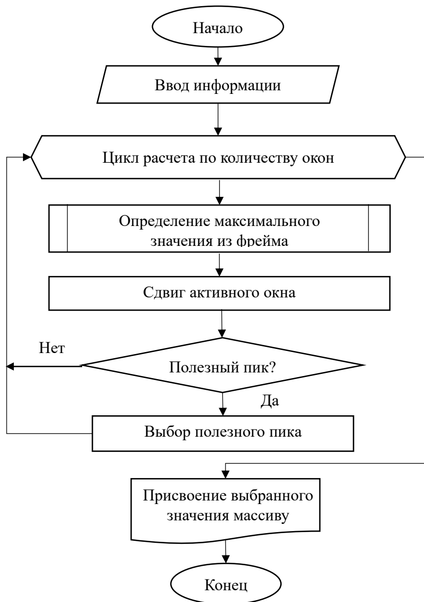
Рис. 2. Усовершенствованный алгоритм определения основных формантных частот
