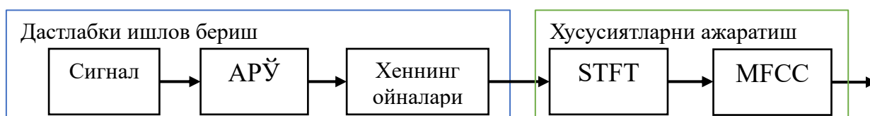
5-расм. DSP, FPGA тизимларида сигналларга ишлов бериш босқичлари
