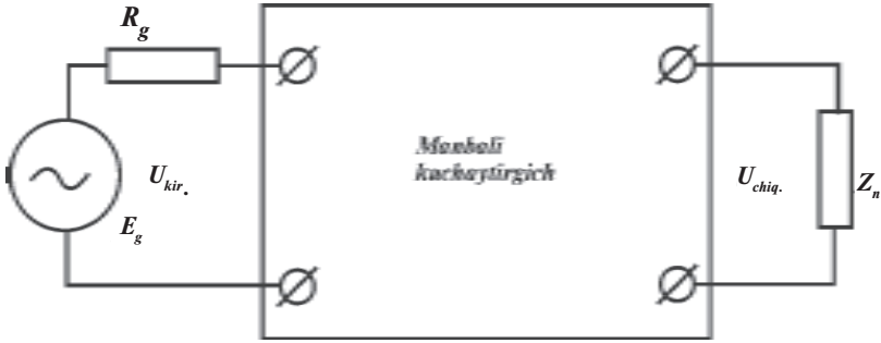
2.41-rasm. Faol to'rt qutbli kuchaytirish asbobi.
