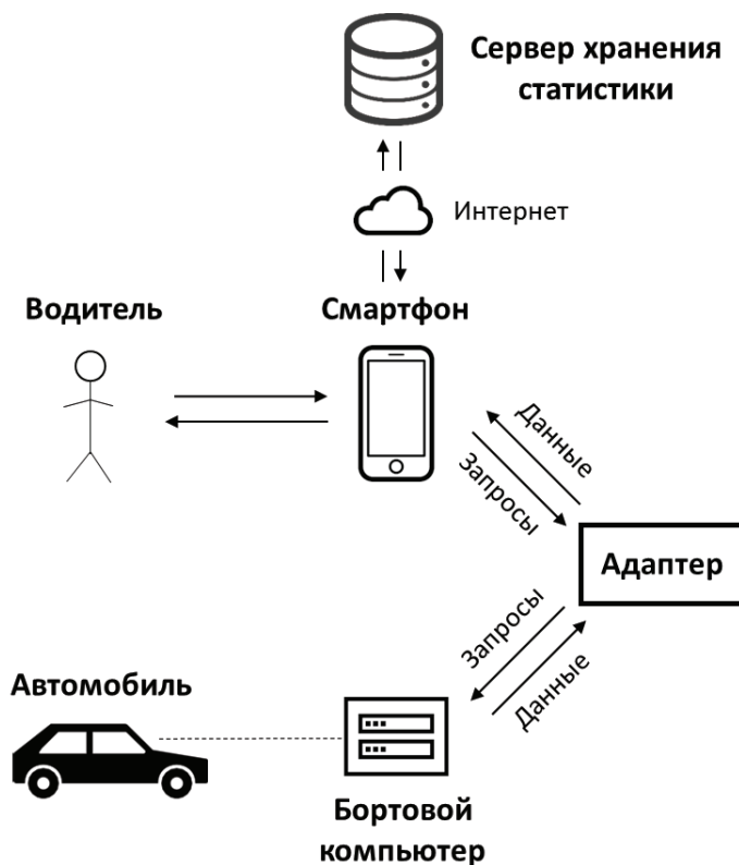
Рис. 4. Получение и сбор диагностической информации автомобиля при помощи специального адаптера и разрабатываемого программного модуля, работающего на мобильном устройстве
