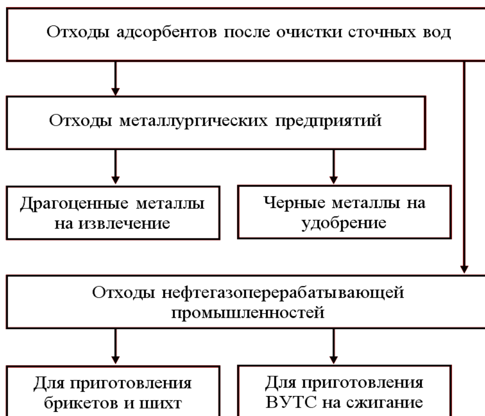
Рис.6. Схема использования отработанного угольного адсорбента после очистки стоков
