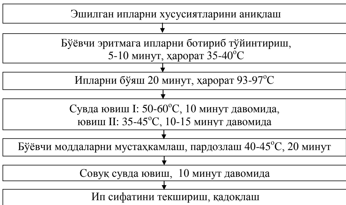
11-расм. Вискоза кашта ипини бўяш технологиясини кетма-кетлиги
