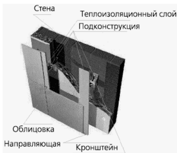
Рис. 3. Элементы конструкции стены с вентилируемым воздушным фасадом
