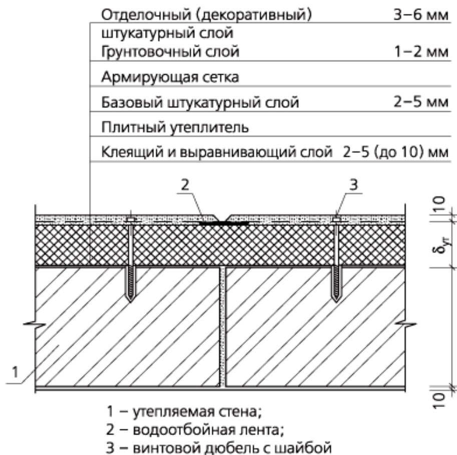
Рис. 5. Фасадная система с тонкослойной штукатуркой и жесткими крепежными элементами
