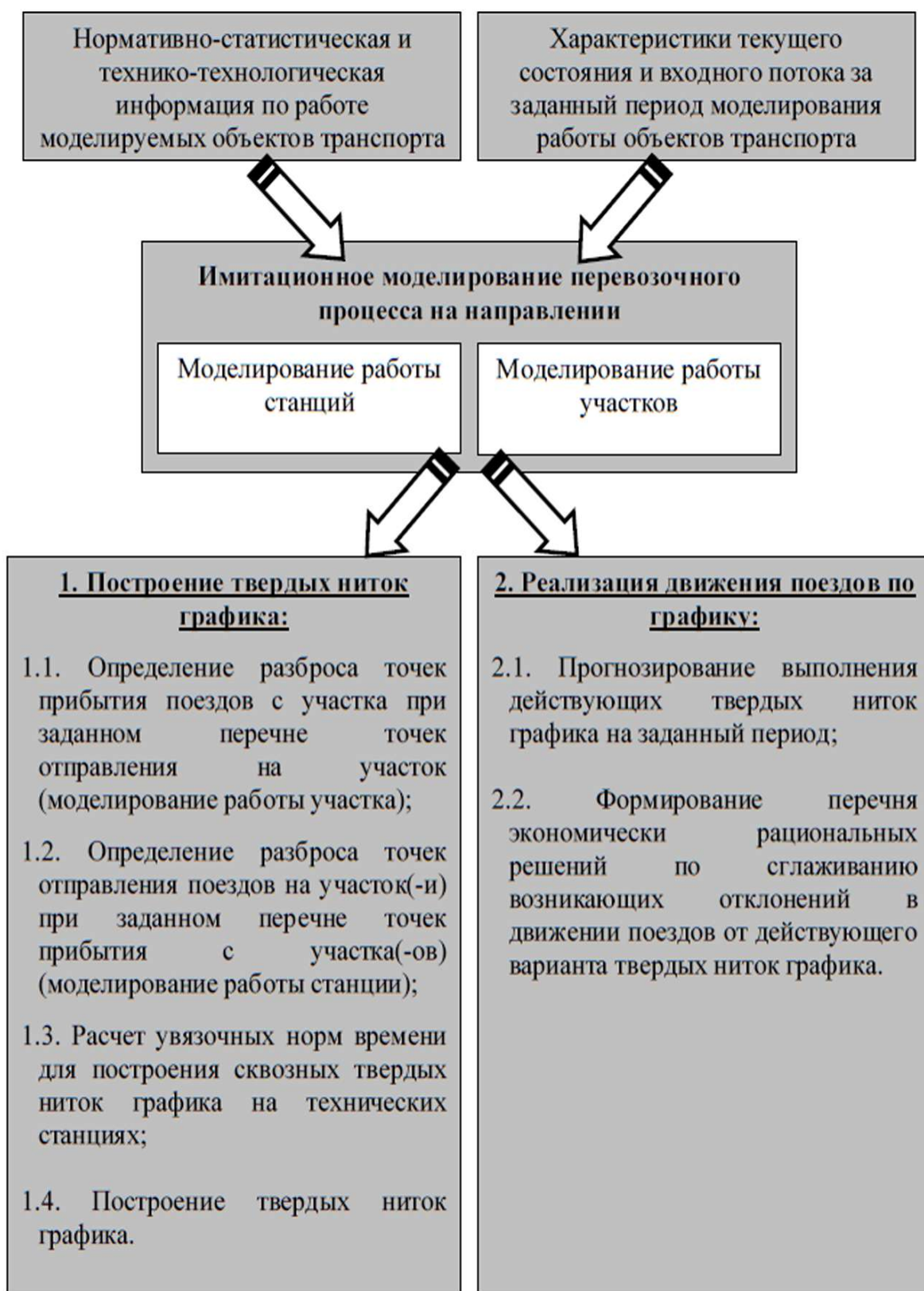
Рис. 3.2.3. Задачи моделирования перевозочного процесса в условиях организации движения грузовых поездов по твердым ниткам графика
