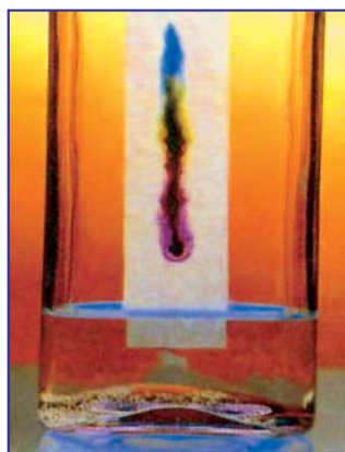
11-сурет. Заттар қоспасын фильтрлеу (а, ә, б), айырғыш воронка (в) және хроматографиялық әдіс (г) көмегінде құрамдық бөліктерге айыру
