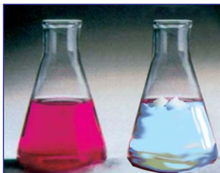
38-сурет. «Құрғақ мұз» және оның фенолфталеин сілті ерітіндісімен әсерлесіп нейтралдануы және индикатор түсінің жойылуы
