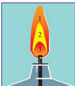
5-su'wret. Spirt lampasi' jali'ni'ni'n du'zilisi.
