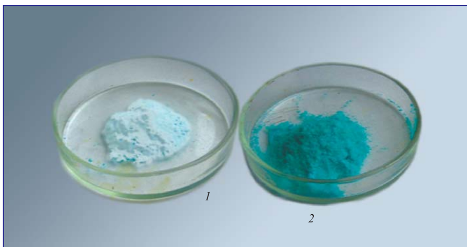
Рис. 48. Образцы солей: сульфат меди \text{CuSO}_4 (1) и содержащий кристаллизационную воду медный купорос \text{CuSO}_4 \cdot 5\text{H}_2\text{O} (2)
