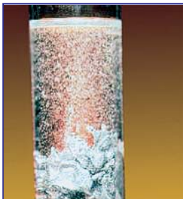
42-rasm. Fenolftaleinli ishqor eritmasini kislota eritmasi bilan neytrallashda indikator rangining yo'qolishi.
