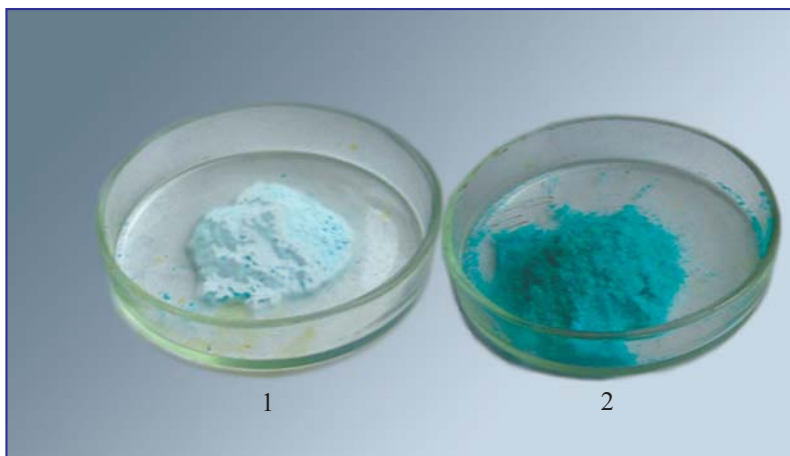
49-rasm. Tuzlar namunalari: mis sulfat \text{CuSO}_4 (1) va kristallizatsion suv tutgan mis kuporosi \text{CuSO}_4 \cdot 5\text{H}_2\text{O} (2).
