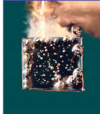
43-rasm. Ruxning sulfat kislodata erishi va vodorod ajralib chiqishi.
