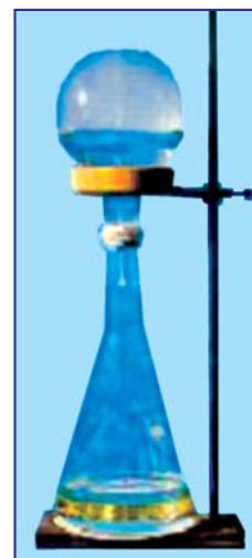
48-rasm. HCl gazining suvda erib, xlorid kislota eritmasini hosil qilishi.
