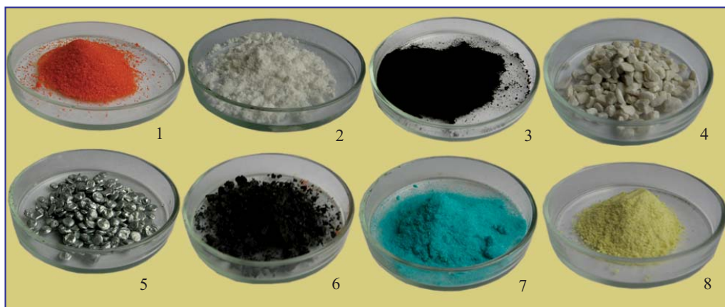
36-rasm. Oddiy va murakkab moddalarning namunalari: 1–kaliy bixromat; 2–kaliy xlorid; 3–mis (II)-oksid; 4–ohaktosh; 5–rux metali bo‘lakchalari; 6–ko‘mir; 7–mis kuporosi; 8–oltingugurt.
