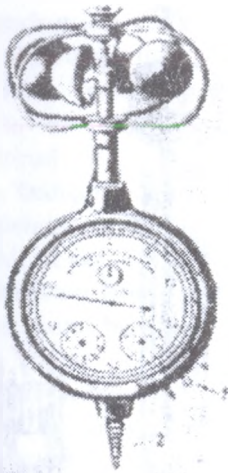
17-rasm. Anemometr. 1-arretir; 2-o'rnatish vinti.
