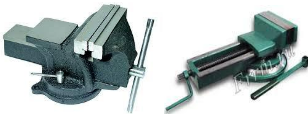
1.5-rasm. Parallel tiskilar: a—parallel jag'li burilma tiskya: b—strubtsinali tiski.
