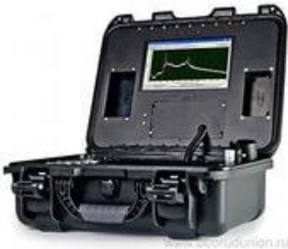
2.2-расм. Замонавий комбинацион сочилиш спектрометрнинг ташқи кўриниши
