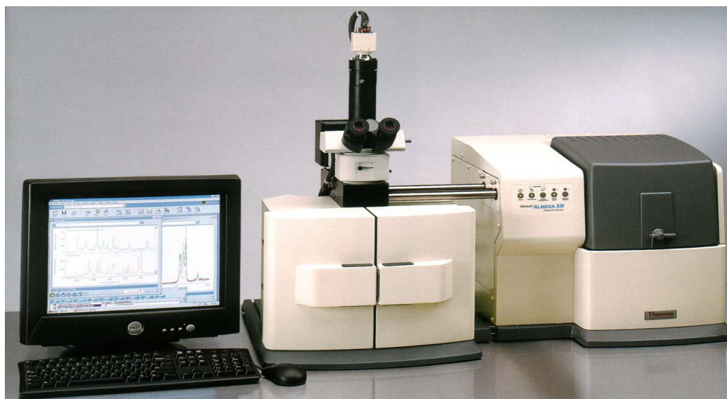
2.3-расм. Юқори эффективли дисперсион комбинацион сочилиш спектрометрининг ташқи кўриниши
