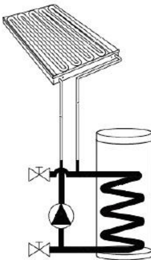
1.7-расм. Дренаж баки бўлмаган ўз-ўзини сувдан бўшатадиган гелиоқурилма. Насос тўхтаган вақтдаги ҳолати
