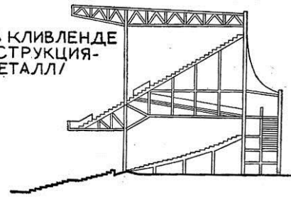
7. ВИСЯЧЕЕ ПОКРЫТИЕ НАД СТАДИОНОМ НА 150 000 МЕСТ ПРОЛОТОМ 330x305м. / ПРОЕКТ - Г Д Р /
