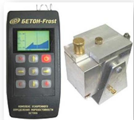
Базируется на дифференциальном методе измерения объемных деформаций водонасыщенного образца и эталона, помещенных в измерительные камеры. Эталон выполнен из алюминиевого сплава в виде 100-мм составного куба с цилиндрической полостью d70x70мм под керн и цилиндра d70x70мм.
