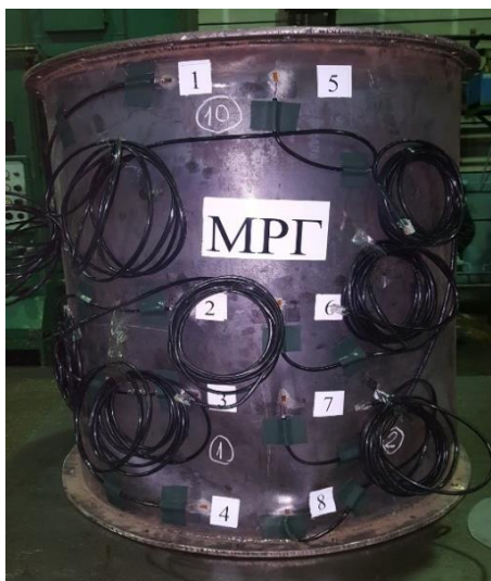
Рис.4. Вид неподкрепленной гладкой модели оболочки МРГ после испытания
