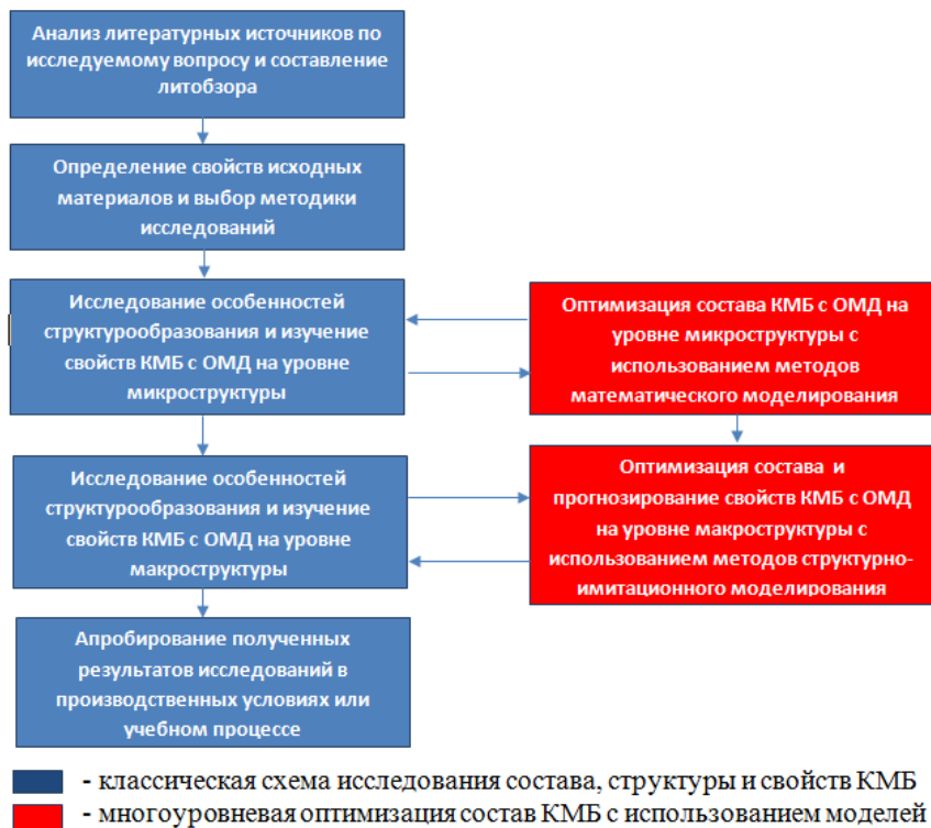
Рисунок 6. Методологическая схема многоуровневой оптимизации состава КМБ
