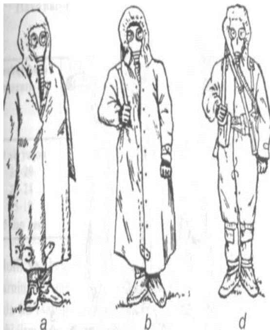
44-rasm. Umumqo'shin himoya to'plamini «jangovar» holatga o'tkazish usullari: a - himoya to'plami «yoping'ich» holatida kiyilgan; b - himoya to'plami «yengiga» holatida kiyilgan; d - himoya to'plami «kombinezon» holatida kiyilgan.
