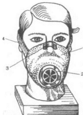
39-rasm. R-2 respiratori: 1 - yarim niqob; 2 - nafasni chiqaruvchi klapan; 3 - burun qisqichi; 4 - rezinadan tayyor-langani egiluvchan tasma.
