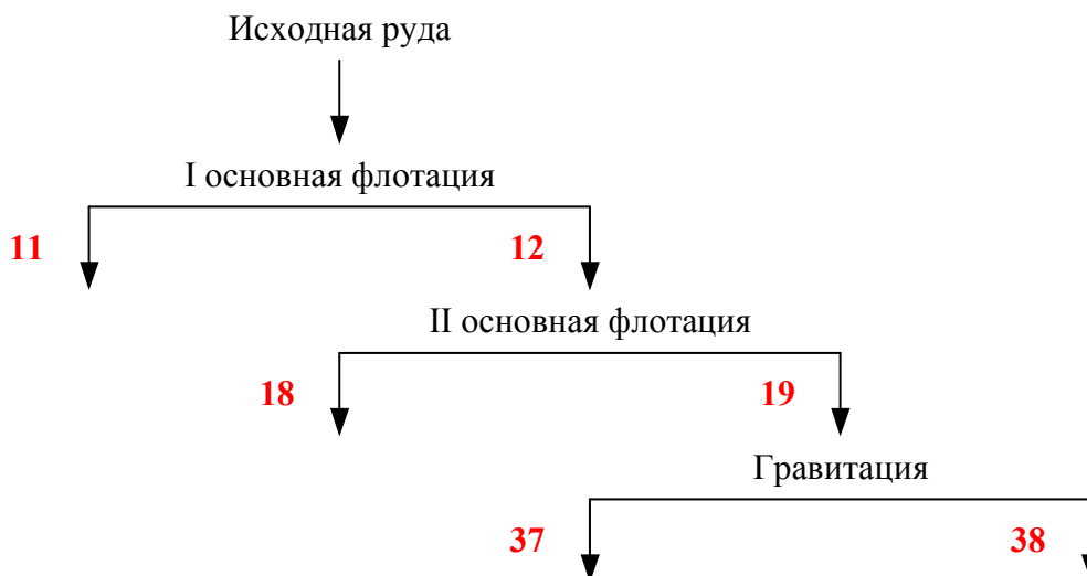
Рисунок 2.2. – Принципиальная технологическая схема переработки первичной золотомышьяковой руды
