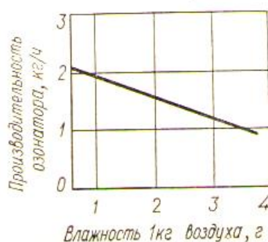
Рис. 12.6. Влияние влажности воздуха на генерирование озона.
