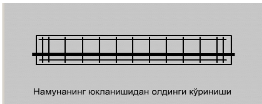
Чизма-6. Тўсин тузилиши ва синаш схемаси;
