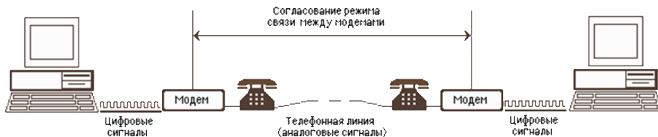
Рис. 2.24. Схема реализации модемной связи
