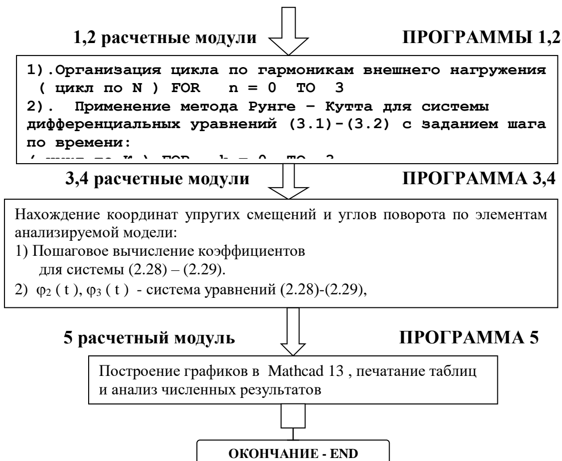
Рисунок 2.2 - Численное исследование по модели упругого оболочечного элемента, зажатого ребрами жесткости, для пневматических рессор электровозов
