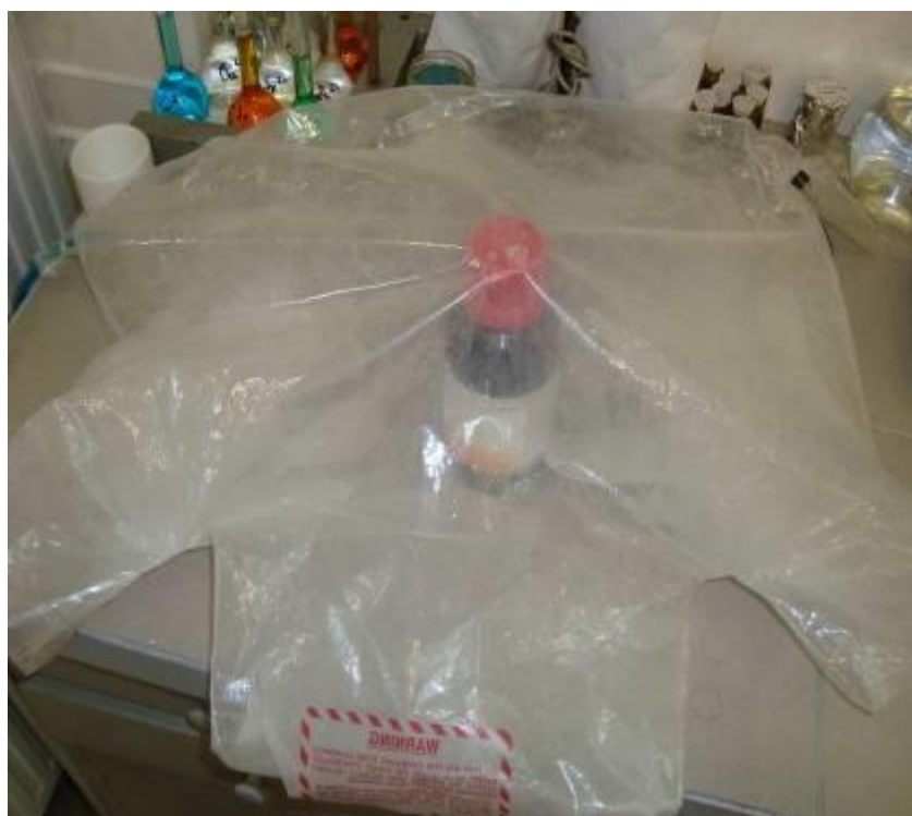
Рис. 2. Устройство Glove box для смешивания компонентов в регулируемой газовой среде.
